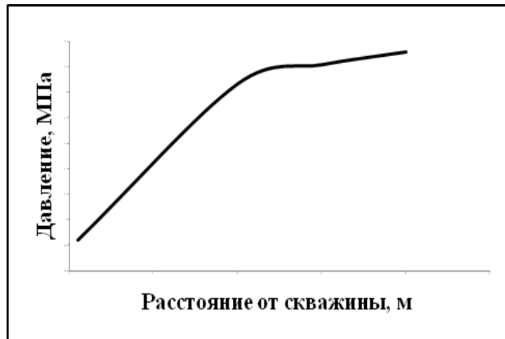
Р и с. 8. Эпюра распределения давления в окрестности скважины (общий вид)
