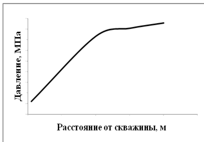
Р и с.10. Эпюра распределения давления в окрестности скважины (общий вид)
