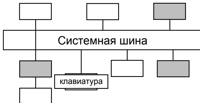
Рис. 3.1. Структура персонального компьютера с шинной архитектурой
