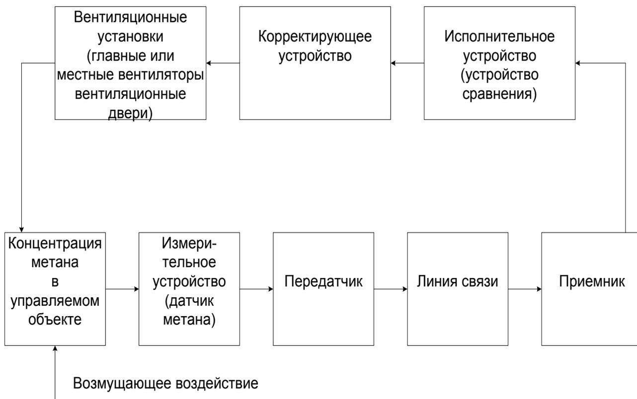
Структурная схема автоматизации
