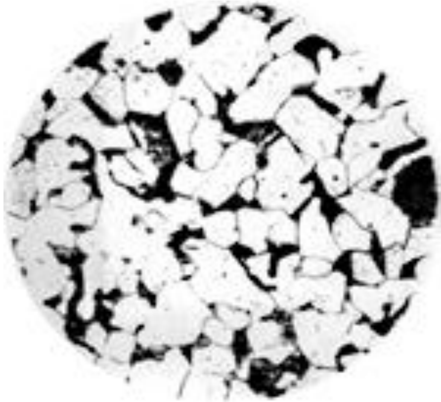
Рис. 2. Фотография мезоструктуры доэвтектоидной стали – Сталь 20. (Избыточный феррит (светлые зерна, матрица) и перлит (включения)).
