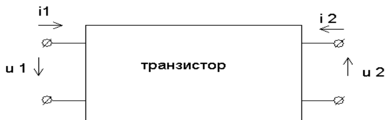
Рис.1.4. Эквивалентная схема транзистора в виде четырехполюсника.
